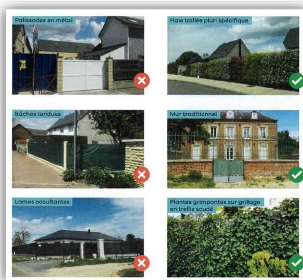
en bois non jointives, gabion de tonalité pierre locale, grillages simple torsion en métal galvanisé ou les treillis soudés verts ou gris, doublés idéalement d'une haie, les grilles en acier non festonnées, les murs en matériaux traditionnels tels que pierrecalcaire, silex, brique, grés, torchis, bauge, pans de bois surmontés d'un chaperon en brique, tuiles ou pierres, sont à privilégier. Les soubassements béton sont interdits et les poteaux doivent être de la même teinte que le grillage.
